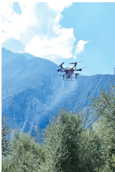
针对油橄榄的无人机飞行高度控制在 0.5~3 米
