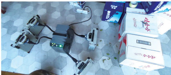
物资准备 – 多块电池充电以保证无人机喷施作业连续性
