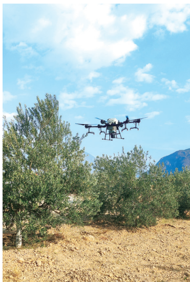
针对油橄榄的无人机飞行高度控制在 0.5~3 米
