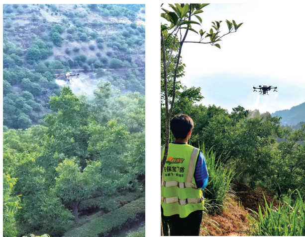
针对核桃的无人机飞行高度控制在 0.5 \sim 5\text{m}
